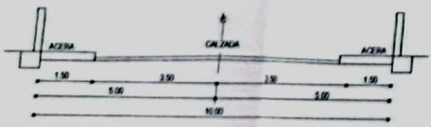
CORTE TÍPICO DE LA CALLE SN. ESCALA — 1:100
